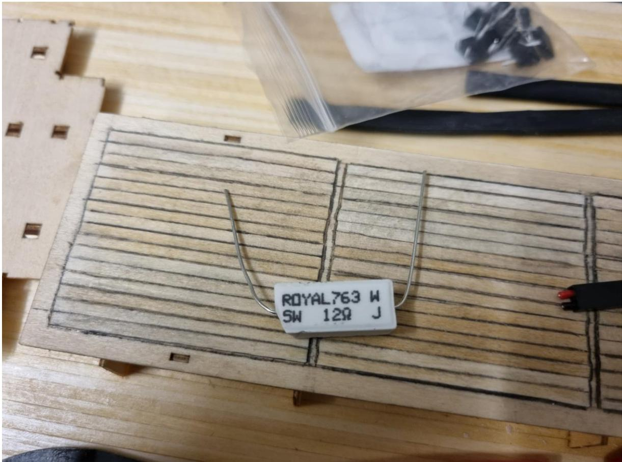
Den Keramikmantel des Widerstands entfernen wir nun vorsichtig durch klopfen mit einem Schraubenzieher oder durch vorsichtiges Abknabbern mit einem Seitenschneider.
