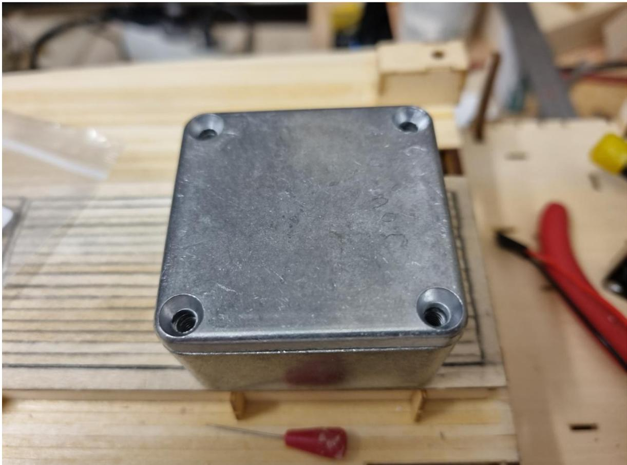
Als Rauchkammer dient eine Alu- (Schalt) dose mit abnehmbarem Deckel.
