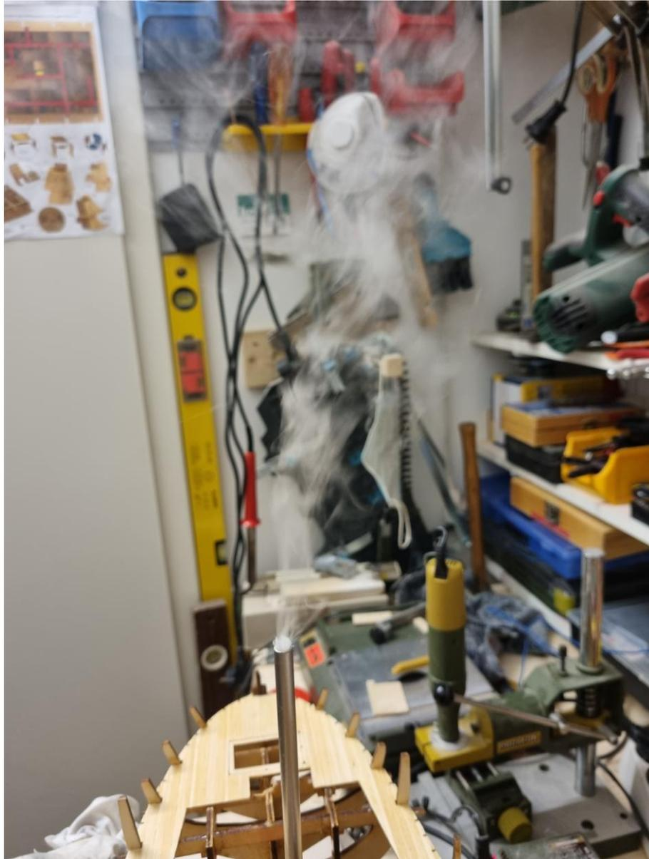
Wie man sieht, funktioniert der Raucherzeuger sehr gut. Die austretende Dampfmenge variiert je nach Stellung des Gashebels. Natürlich ist die Dampfmenge über die Heizung etwas träge. Insbesondere beim Start dauert es ca. 30 Sekunden, bis die Heizung ausreichend warm ist. Beim Verringern der Motordrehzahl reagiert die Heizung jedoch gut.
